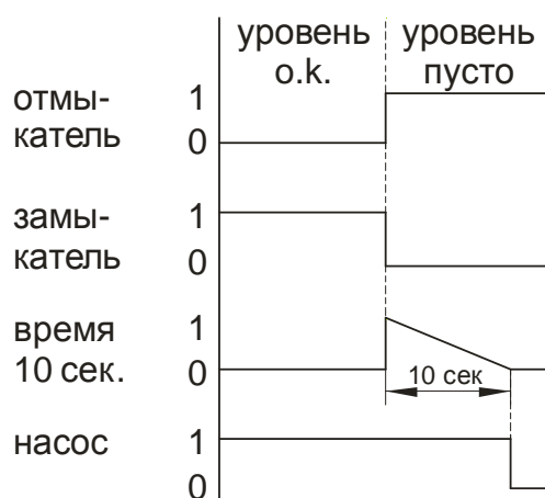
Схема подключения прибора контроля за уровнем смазки
